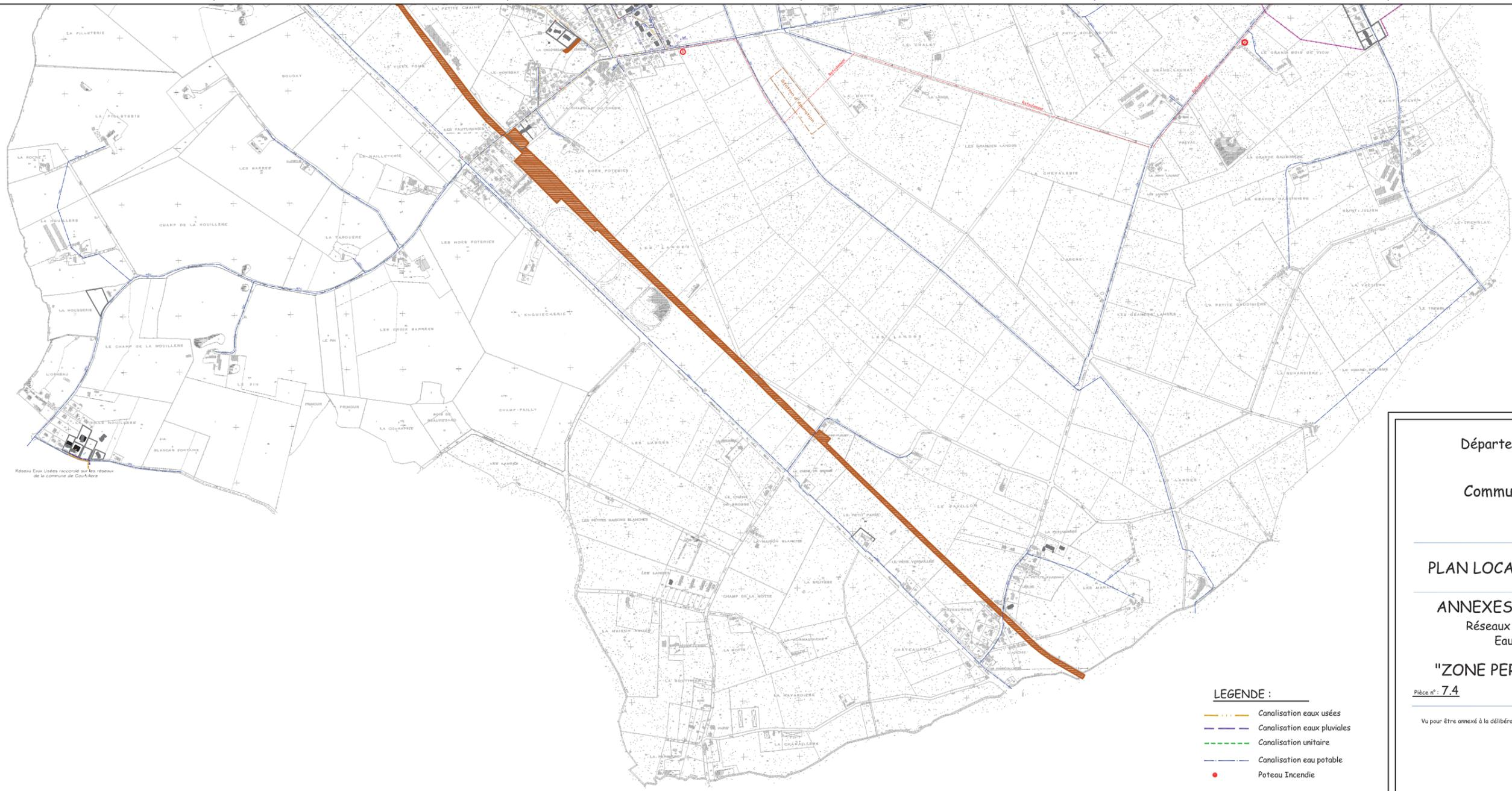
Réseau Eau Usée raccordé sur les réseaux de la commune de Courferron
